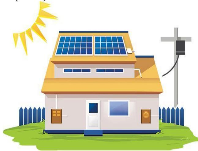
A instalação de placas fotovoltaicas para consumo próprio tem como empecilho o fato de o sistema gerar energia elétrica apenas durante o dia, quando há insolação, tendo seu pico ao meio-dia. Em virtude disso, é necessário gerar um excedente durante o dia, para compensar o consumo noturno. O excedente para ser aproveitável deverá ir para algum lugar, afinal, energia elétrica é algo instantâneo. Ela deve ser utilizada imediatamente ou armazenada de alguma forma.
